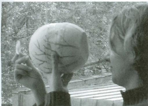
Abb. 2: Korrektur der Fehlsichtigkeit (Kurzichtigkeit) durch eine Linse
