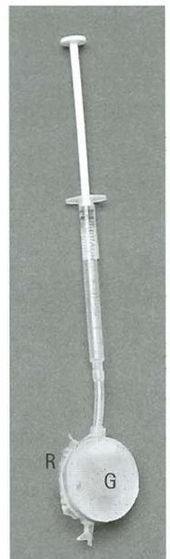
Abb. 3: Akkommodationsfähiges Augenmodell, a) Außensicht und b) Innensicht
