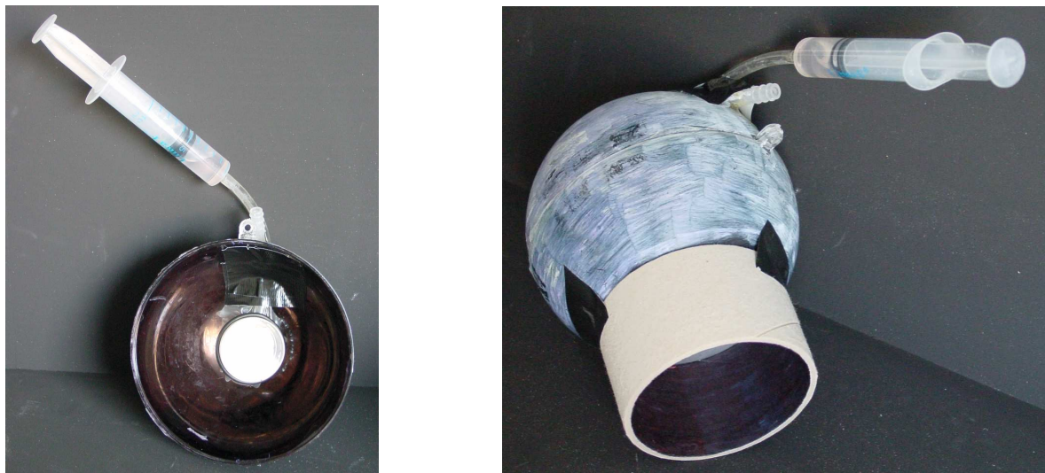
Abbildung 4: Blick auf die mit Wasser gefüllte Linse ( links ), fertiges Augenmodell ( rechts )
