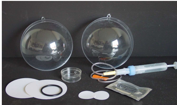
Abbildung 3: Materialien, die zum Bau der Augen erforderlich sind ( links ), mit Sandpapier abgeriebene Halbkugeln ( rechts )
