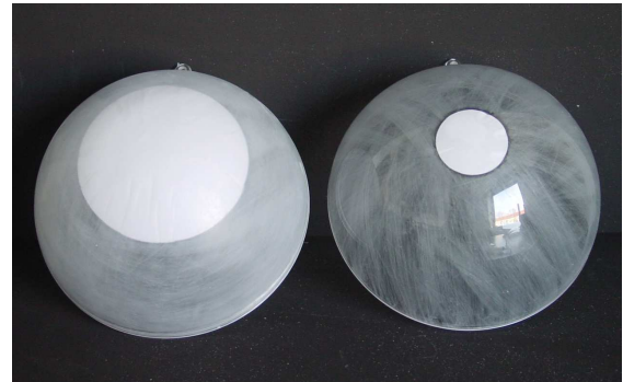
Abbildung 3: Materialien, die zum Bau der Augen erforderlich sind ( links ), mit Sandpapier abgeriebene Halbkugeln ( rechts )
