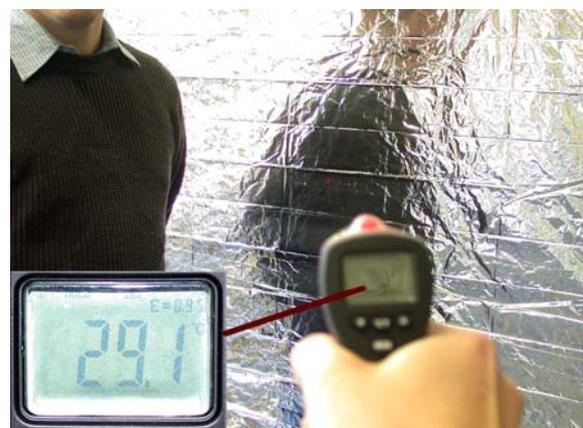
Abb. 8: Reflexion von Infrarotstrahlung an einer Rettungsdecke.
