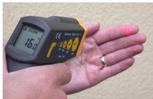
Abb. 7: Strahlungsthermometer (Achtung: Bei der Messung der Fingertemperatur ist der D/S-Wert des Gerätes zu beachten).
