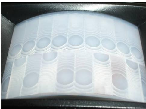
Abb. 3: Die Fresnellinsen unterteilen den Erfassungsbereich in einzelne Sektoren.
