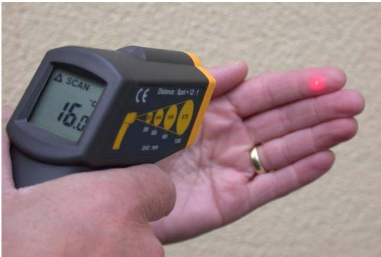
Abb. 4: Strahlungsthermometer
